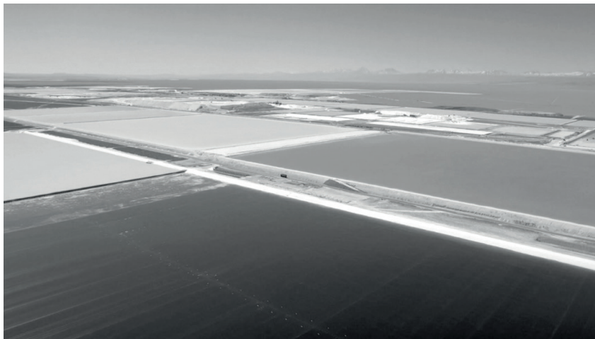
Imagen 3. Ampliación de piscinas de evaporación de litio en planta Albemarle, Salar de Atacama (2017)
